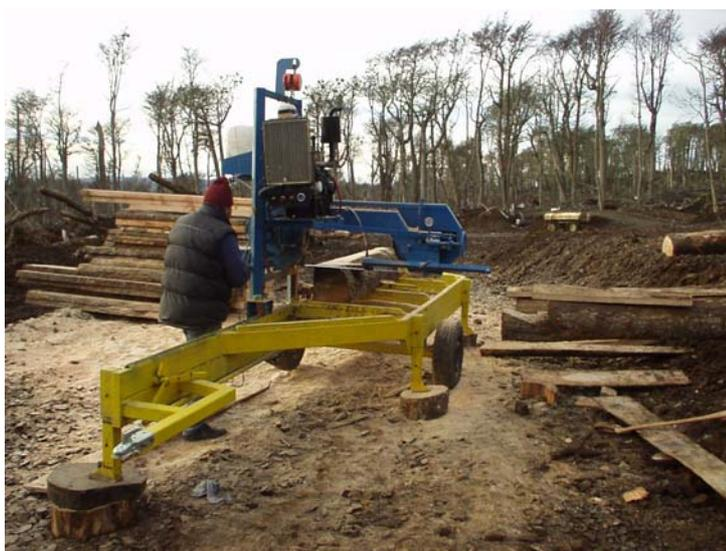
*Foto: Aserradero portátil procesando madera rolliza en el lugar de extracción.*
