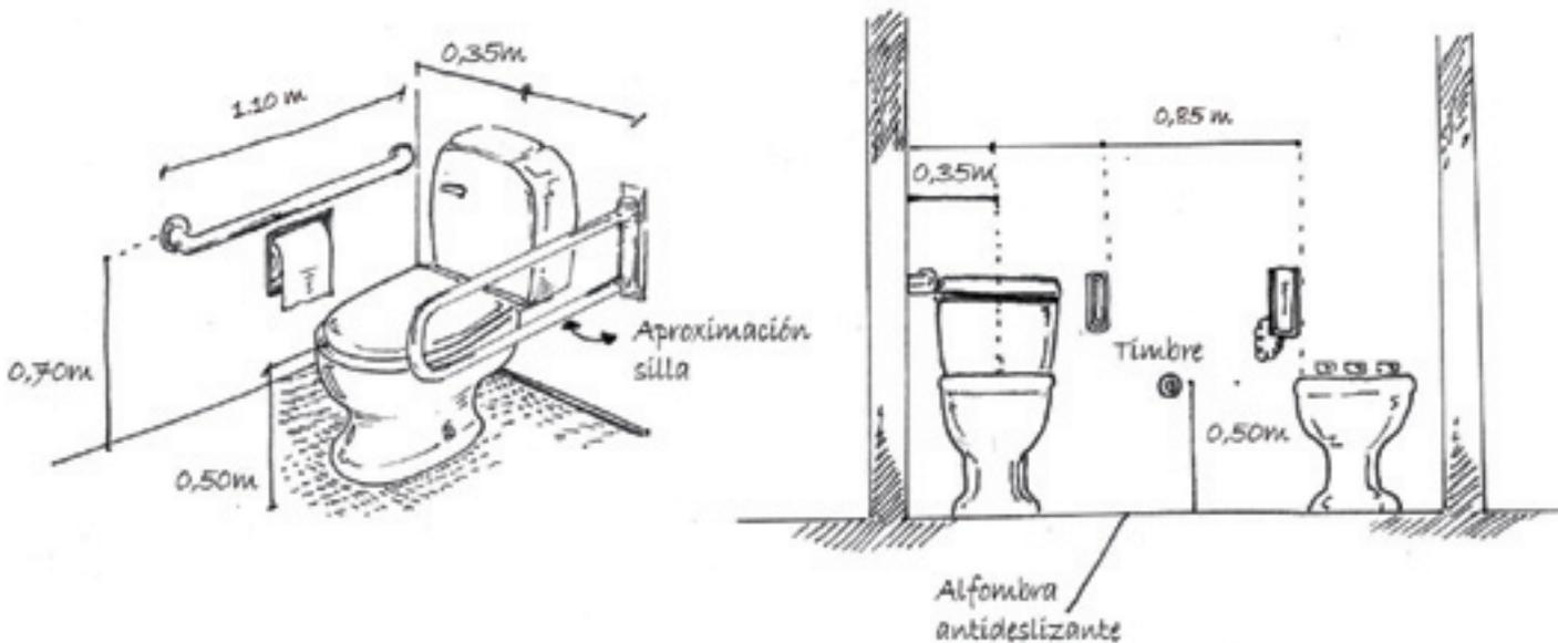
Las fijaciones al piso deberán ser reforzadas a los efectos de poder soportar los esfuerzos laterales de traslado de la persona, desde la silla de ruedas al inodoro. Por su parte, las tapas de los inodoros deberán ser de madera y con fijaciones metálicas.
